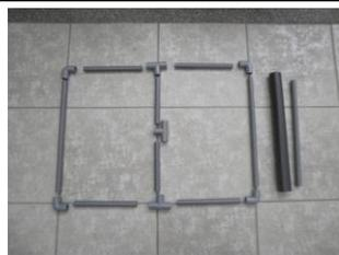
準備 20 公分塑膠管 6 支、45 公分塑膠管 3 支、三通 3 個、彎管 4 個、保溫軟管約兩尺（以上均為 6 吋管徑）。
