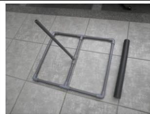
將 45 公分塑膠管插入中央的三通作為支柱。前後搖晃並調整各管與彎管、三通的緊度。
