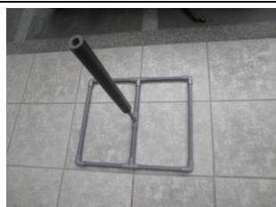
套上軟管。可視支柱與軟管的鬆緊程度，在塑膠管上端纏幾條橡皮筋，以增加止滑效果。
