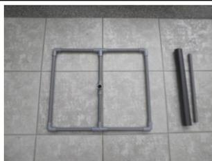
將所有塑膠管（1 支 45 公分塑膠管除外）、三通、彎管如圖組成合底座（加壓套接，不用膠）。
