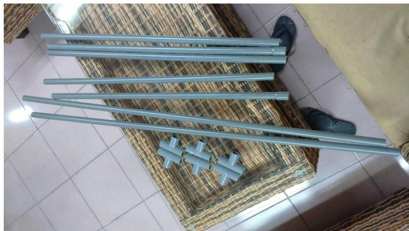
(1) 首先將 T 字管與 1.5 公尺的水管相接，T 的橫邊與水管平行(如照片)。
