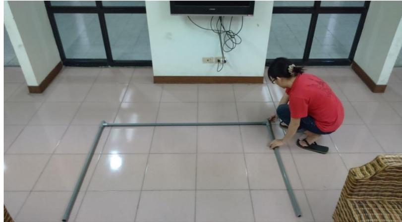
(3) 1 公尺的另一端也加上 T 字管，短邊朝上接上另一支 1 公尺水管。
